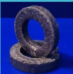
**РК-СФ-Г:** Сальниковая набивка изготовлена из стекловолоконных нитей с последующей пропиткой в глубоком вакууме графитонаполненной фторопластовой суспензией
