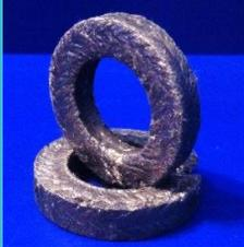
**АППП:** Плетеная, с латунной проволокой, прорезиненная, пропитанная антифрикционным составом, графитированная, представляет собой эластичный шнур квадратного или прямоугольного сечения, сплетенный из асбестовой нити с латунной проволокой диаметром 0,17-0,2 мм.
