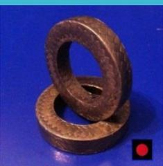
**PK-502CC:** Набивка сальниковая фторопластовая из волокон экспандированного графитонаполненного фторопласта с демпфирующим силиконовым сердечником, позволяющим компенсировать небольшие биения вала. Толщина сальниковой набивки 3мм-50мм.
