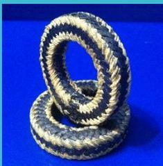
**PK 502-АФ:** Сальниковая набивка из графитонаполненного фторопласта с угловой оплеткой арамидными волокнами. Используется в основном в плунжерных насосах, клапанах и арматуре. Угловая оплетка фторопласта нитями арамида, предотвращает холодную текучесть фторопласта и препятствует проникновению абразивных веществ в сальниковый узел.
