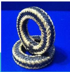
**PK 240-AF:** Сальниковая набивка для применения в плунжерных и центробежных насосах, запорной арматуре и клапанах. Изготовлена на основе терморасширенного графита с угловой оплеткой арамидным волокном. Набивка обладает свойствами арамидного волокна, а графитовое тело набивки способствует эффективному теплообмену и низкому коэффициенту трения. Угловая оплетка арамидом обеспечивает прочность набивки, исключает вымывание графита и препятствует проникновению абразивных частиц.
