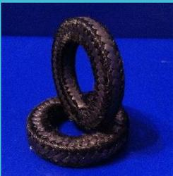
**РК 240-200:** Сальниковая набивка для применения в насосах и арматуре, изготовленная из терморасширенного графита и оплетённая по углам углеродным волокном для придания большей прочности. Комбинация позволяет увеличить стойкость сальниковой набивки к выдавливанию из сальниковой камеры и увеличить механическую прочность.
