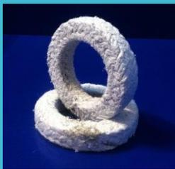
**АСС:** Набивка асбестовая, плетеная, с сердечником из стекловолокна. Предпочтительна для уплотнения неподвижных соединений аппарата при высоких температурах за счет сердечника из стекловолокна имеющего повышенную температуростойкость.
