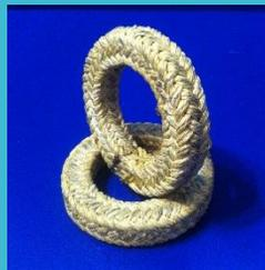
**PK-Ф:** Сальниковая набивка изготовлена из высококачественной арамидной (кевлар) пряжи, пропитанной фторопластовой суспензией. Пропитка суспензией позволяет использовать набивку при скорости вала насоса до 15 м/сек. Необходимо учитывать, что данная набивка имеет очень высокую прочность и эксплуатируется на валах с большой механической твердостью. Очень хорошо зарекомендовала себя в работе в высокоабразивных средах.
