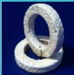
**РК-СФ:** Сальниковая набивка изготавливаемая из стекловолоконных нитей с последующей пропиткой в глубоком вакууме фторопластовой суспензией с добавлением специального состава.
