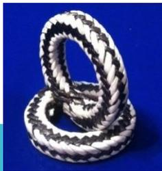
**PK 500-240:** Сальниковая набивка для применения в насосах и арматуре, изготовлена из терморасширенного графита с угловой оплеткой из чистого фторопласта. Угловая оплетка набивки обеспечивает ее прочность, уменьшает износ, исключает вымывание графита в зазоры сальникового узла.
