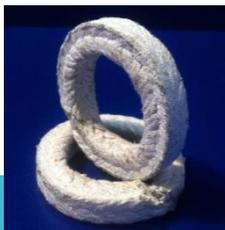
**АФТ:** Набивка сальниковая асбестовая плетеная, пропитанная суспензией фторопласта с тальком. Предназначена для заполнения сальниковых камер арматуры, центробежных и поршневых насосов, уплотнения неподвижных соединений различной химической аппаратуры. Набивка используется для уплотнения узлов неподвижных соединений аппаратов, а также для заполнения сальниковых камер арматуры.
