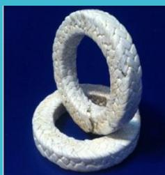
**РК-500Ф:** Сальниковая набивка из нитей экспандированного фторопласта. Обработка данной набивки фторопластовой суспензией позволяет использовать её при более высоких скоростях скольжения.
