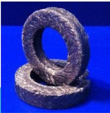
**АПР (АПР-31):** Набивка сальниковая асбестовая плетеная, с латунной проволокой, пропитанная жировым антифрикционным составом, графитированная. Армирование волокон асбеста латунной проволокой придает набивке АПР большую стойкость при высоких температурах и давлениях по сравнению с набивкой марки АП.
