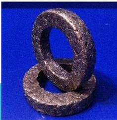
**РК-АПРПФ:** Сальниковая набивка изготовлена из асбестовых нитей, пропитанная графитонаполненной фторопластовой суспензией
