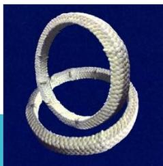
**РК-АФ-В:** Сальниковая набивка, плетённая из арамидных (кевлар) волокон, каждое из которых предварительно пропитано фторопластовой суспензией. После процедуры плетения готовая набивка подвергается дополнительной пропитке в глубоком вакууме, что позволяет увеличить сопротивляемость давлению до 40Мпа.
