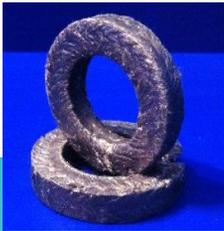
**АГИ:** Асбестовая плетеная, проклеенная с графитом ингибированная. Набивка предназначена для заполнения сальниковых камер арматуры, неподвижных соединения аппаратов, насосов. Предпочтительна для работы в среде пара. Добавление при производстве ингибитора коррозии защищает арматуру работающую при высоких температурах пара от закипания. Набивка используется для уплотнения узлов неподвижных соединений аппаратов, а также для заполнения сальниковых камер арматуры.
