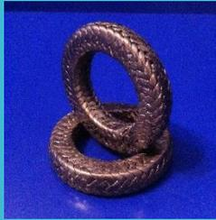
**PK 502-240:** Универсальная сальниковая набивка из высококачественной пряжи терморасширенного графита с угловой оплеткой пряжей графитонаполненного фторопласта. Низкий коэффициент трения и хорошая теплопроводность делают набивку идеальным уплотнением узлов с вращающимися валами, роторных и поршневых насосов, мешалок, миксеров и др. Угловая оплетка обеспечивает прочность набивки. Для применения в арматуре набивка может быть выполнена с армированием проволокой.
