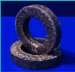
**ХБП (ХБП-31):** Сальниковая набивка плетеная, хлопчатобумажная, пропитанная жировым антифрикционным составом, графитированная. Под заказ набивка ХБП-31 изготавливается неграфитированная.
