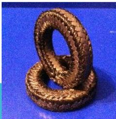
**PK 502-200:** Сальниковая набивка из графитонаполненного фторопласта с оплетением по углам низкотемпературным углеродным волокном. Комбинация обеспечивает набивке пластичность фторопластового волокна и жесткость углеродной пряжи. Угловая оплетка фторопласта углеродным волокном позволяет предотвратить выдавливание фторопласта и уменьшает проникновение абразивных частиц. Набивка применима во всех видах насосов и арматуры.
