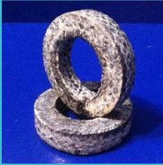
**РК-250:** Сальниковая набивка изготавливается из тонкого углеволокна (карбона) пропитанного фторопластовой суспензией. Предназначена для использования, как в насосах так и в арматуре в таких средах, как: вода, пар, углеводороды до 300 °С. Рекомендуется устанавливать крайние кольца при использовании более мягкой набивки. Отличная замена асбестовой набивки АФТ, АП, АПР, АПРПП. Длительный срок эксплуатации
