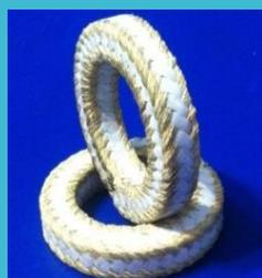
**РК 500-АФ:** Сальниковая набивка из чистой фторопластовой пряжи с угловой оплеткой арамидным волокном, пропитанной фторопластовой суспензией. Данная комбинация обеспечивает пластичность фторопластового волокна и жесткость арамидной пряжи. Подходит для использования в плунжерных насосах, арматурах и в клапанах высокого давления. Сальниковая набивка РК 500-АФ благодаря угловому усилению арамидным волокном, используется в качестве замыкающих колец с сальниковыми набивками из чистого фторопласта.
