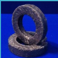
**АП (АП-31):** Набивка сальниковая асбестовая плетеная, пропитанная жировым антифрикционным составом, графитированная. Используется для уплотнения узлов неподвижных соединений аппаратов, а также для заполнения сальниковых камер арматуры, поршневых и центробежных насосов.
